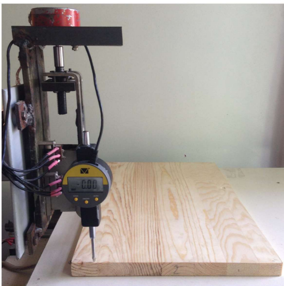
Рис. 2. Експериментальна установка з ЧПУ для визначення формостійкості
